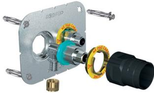
Pour la fixation d'une robinetterie sur une cloison en plaque de plâtre ou alvéolaire. Pour tube PER ou PB Ø 12 mm et 16 mm. Entraxe 50mm
