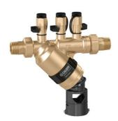
Disconnecteur à zone de pression réduite contrôlable. Protection des réseaux d'eau potable. Température maxi admissible Ts : 65°C. Pression maxi admissible Ps: 10 bars.
