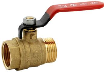
Dimensions : DN 3/8 à DN 2. Raccordement : Femelle BSP. Température Mini : -10°C. Température Maxi : +110°C. Pression Maxi : 16 Bars. Axe inéjectable. Tamis inox démontable. Filtration 500 (5/10°). Corps laiton CW617N suivant EN 12165.
