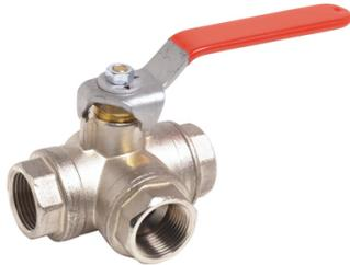
Ouverture droite ou gauche. Corps laiton. Poignée acier. Pour fluides courants compatibles. Température mini/maxi : -10°C/+120°C. Pression maxi admissible Ps : 16 bar. Pression différentielle 5 bar maxinde.
