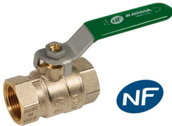
Garantie 10 ans. Double étanchéité à l'axe. Rétention du fluide limitée. Poignée et écrou anti-corrosion. Laiton conforme à la norme EN12165. Traçabilité totale date de fabrication, origine, logo. PN40 du 1/4 au 3/4. PN25 en 1?? et 1??1/4. ACS et conforme 4MS.
