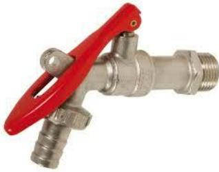
Utilisation de distribution d'eau - Raccord au nez. Brise jet incorporé - Axe inéjectable - Bille pleine - Etanchéité de l'axe par 2 joints toriques - Poignée acier. Cadenassable - PN16.
