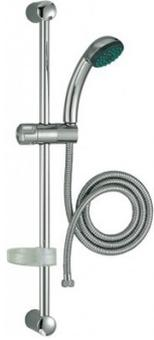
Set de douche avec barre murale. Barre murale de 70 cm. Douchette à main Ø 80 mm, 1 jet. Flexible en métal 1600 mm avec système anti-torsion. Picots à base siliconée anticalcaire. Fixations et support de douchette réglables.
