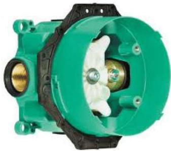
Ibox Universal. Pour toutes robinetteries douche et bain/douche mécaniques et thermostatiques encastrées avec ou sans robinet d'arrêt. Comprend : 1 joint d'étanchéité, 3 réducteurs 3/4"-1/2" et 1 bouchon 3/4".
