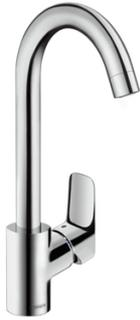
Caractéristiques · ComfortZone 260 · bec orientable possible sur 3 niveaux 110°, 150° ou 360° · jet normal · débit maximal à 3 bars: 12 l/min · cartouche céramique · limiteur de température réglable · convient au chauffe-eau instantané · comprenant: mitigeur de cuisine, flexibles de raccordement, set de fixation, notice de montage
