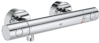
Montage mural apparent. Poignées ergonomiques métal. Butée à 38°C + limiteur de température intégré à 50°C max. Cartouche C3. Régulation thermostatique. Arrêt coupure d'eau froide. Robinet d'arrêt intégré. Poignée de débit touche éco et butée éco réglable séparément. Tête céramique 1/2 180°. Départ de douche 1/2. Clapets anti-retour intégrés. Filtres intégrés. Raccords en S Rosace en métal.
