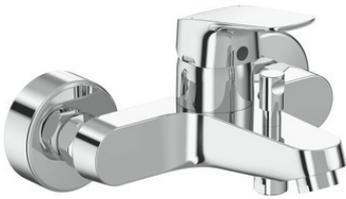
Okyris, mitigeur bain-douche mural, Chrome. Poignée en métal. Inverseur à retour automatique. Sortie de douche 1/2" par le dessous avec clapet anti-retour intégré. Cartouche Ø 38 mm FirmaFlow® avec limiteur de température intégré. Raccords muraux
