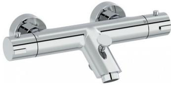
NF : E1 C3 A2 U3 // ACS : 19 ACC LY 719. Consommation d'eau : Limiteur de débit sensitif. Débit : 12 l/mn sous 3 bar. Avec raccords et rosaces murales. Avec Eco conso. Inverseur automatique intégré. Butée de sécurité : 38°C. Température maxi. : 50°C. Aérateur anti-calcaire.
