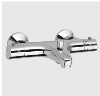
Mitigeur thermostatique bain douche Cartouche thermostatique anticalcaire avec filtres Clapets antipollution Limiteur de température anti-brûlure réglable : Bouton de sécurité avec blocage à 38° Limiteur de débit : Economie d'eau grâce à la butée à 50% du débit.
