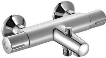
Economie d'eau : butée escamotable à mi-débit. Sécurité et économie d'énergie : blocage température maximum 50°, butée escamotable à 37°. Fonctionne avec un chauffe-eau à accumulation, instantané ou mixte d'eau moins 18 kWh. Aérateur anti-calcaire. Clapet anti-retour sur les alimentations. Inverseur à bouton-poussoir basse pression.
