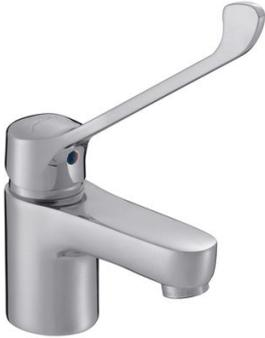
Sécurité : Température maximale pré réglée à 40°C. Durabilité : Flexibles d'alimentation PEX haute résistance. Ergonomie : La cartouche séquentielle permet ouverture/fermeture et réglage de la température par déplacement horizontal du levier. Manoeuvre aisée : Grâce au levier long 150 mm.
