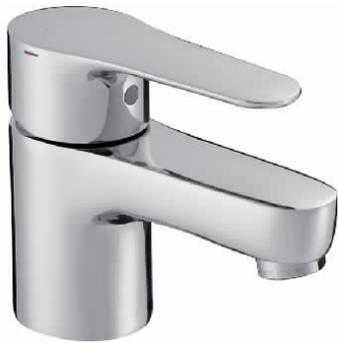
Hauteur sous bec : 5 cm. Hauteur totale : 11,4 cm. Avec flexibles d'alimentation et bonde de vidage mixte. Limiteur de débit sensible. Tirette latérale. Aérateur anticalcaire. Saillie 110 mm.
