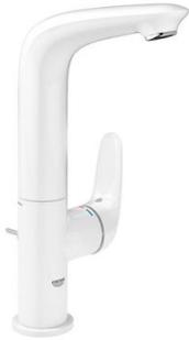
Mitigeur monotrou. Poignée solide en métal. Cartouche en céramique 28 mm. Limiteur de course. Chrome éclatant et durable. Mousseur économique, 5,7 l/min. Installation rapide. Bec mobile. Rotation: 360°. Vidage automatique 1"1/4.
