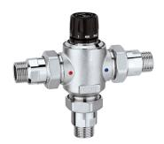
Corps laiton matricé, Ressort acier inox et Joints EPDM. Pression statique maxi 14 bar / Dynamique : 5 bar. Température maxi 85°C. Rapport maxi entre les pressions EF/EC 2:1. Différence mini entre les températures EC et EM pour un fonctionnement optimal : 15°C.
