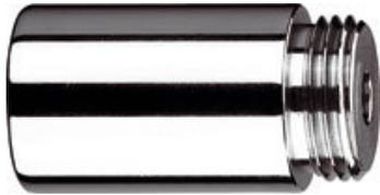
Limiteur thermostatique de température au point de puisage. Sécurité antibûlure : l'appareil se ferme à 48°C +/-2°. En position sécurité : la cartouche laisse passer un goutte à goutte sans danger pour l'utilisateur. Corps laiton, chromé, Ressort acier inox, 1/2" MF.
