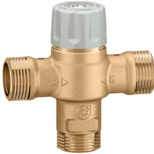
Mitigeur 3/4" avec sécurité anti-brûlure avec filtres et clapets intégrés, kvs de 1.85 pour une perte de charge de 1 bar. Plage de réglage : 30 - 50°C.
