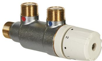
Plage de réglage : 34 / 40 °C. Précision : +/- 1,5 °C. Pression maxi. de fonctionnement : statique : 10 bar, dynamique : 5 bar. Rapport maxi. entre les pressions en entrée : 2:1. Température mini entre entrée et sortie : 10 °C. Débit maxi. sous Dp de 1 bar : 19 l/min. Clapets intégrés.
