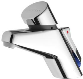
Avec robinet d'arrêt. La bague est de couleur noire. Durée d'écoulement : 15 secondes  $\pm$  5 secondes réglable par bague 4 positions. Débit : Limiteur de débit 5 l/mn. Réglage 5 positions inaccessible par l'utilisateur. Dispositif anti-coup du béliet : fermeture du robinet par diminution progressive du débit. Brise-jet : Antivandalisme et anti-bouchage. Filtre à gravier incorporé dans le module hydraulique.
