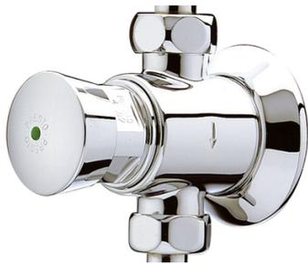
Avec raccords 12x14. Alimentation en ligne. Arrivée mâle 1/2" (15x21). Sortie droite ou équerre mâle 1/2" (15x21). Durée d'écoulement : 6 secondes (± 2 secondes). Débit : 9l/mn à 1 bar (réglable par l'installateur en fonction de la pression). Réglage 4 positions. Livré avec : Joint plat et écrou raccord, Ecrou pour tube 12x14, Rosace solidaire du robinet.
