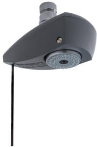
Le robinet temporisé à pomme suspendue permet l'écoulement d'eau par simple action verticale sur le câble. L'eau s'arrête automatiquement après une temporisation réglée en usine de 30 secondes. Alimentation plafond mâle 20 x 27. Réglage de débit et de la temporisation inaccessibles aux usagers. Limiteur pré-réglé à 10 l/mn à 2 bar (accessible sans coupure d'eau)
