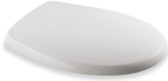
Abattant de WC en Polypropylène incassable. Poids 1,250 Kg, dimensions: L 440 mm, l 370 mm. Angle d'ouverture 108°. Adapté à toute cuvette normalisée avec entraxe de fixation compris entre 130 et 180 mm.
