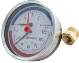
Manothermomètre axial 0 / 4 bar, 0 / 120 °C, D.80 mm, avec douille 1/2".
