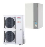
Hautes performances assurant un départ d'eau à 60 °C jusque -20 °C extérieur. Jusqu'à 12 kW disponibles à -7 °C extérieur pour 55 °C de départ. Économies d?énergie : Classe énergétique jusque A++. Facilité d'installation : Paramétrage facile grâce au questionnaire de démarrage EASY START. Appoint électrique intégré de série. Pas de vanne filtre à prévoir grâce à l'échangeur coaxial et son volume tampon. Chauffage seul
