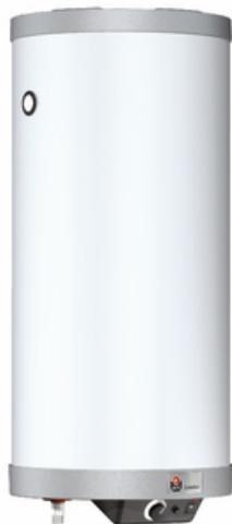
Préparateur d'eau chaude sanitaire pour installation au sol ou murale verticale ou horizontale. Réservoir sanitaire interne en acier inoxydable. Doigt de gant inox pour thermostat ou sonde. Isolation en mousse en polyuréthane rigide. Jaquette extérieure en polypropylène. Anti-légionelles : température de stockage > 60°C. Vanne de mélange thermostatique recommandée. SYSTÈME TANK-IN-TANK
