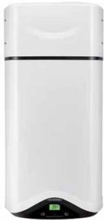
Capacité totale : 110 L. Production d'eau chaude à 40°C : plus de 360 litres par jour en mode pompe à chaleur (air à 7°C) ? donc idéal en remplacement d'un 200 litres connecté en jour/nuit. COP selon EN16.147 = 2.24 à 7°C d'air. Anode : Titane et magnésium. Température de fonctionnement de la pompe à chaleur : -5°C à +42°C. Volume d'eau à 40° : 169 litres. Dimensions : H. 139.8 x L. 50.6 x P. 53.5 cm.
