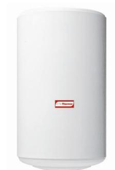
Chauffe eau équipé d'une résistance protégée du calcaire : insérée dans un fourreau, sans contact direct avec l'eau. En cas de remplacement, pas besoin de vidange. Protection anticorrosion : anode en magnésium, qui se dissout dans le temps, nécessite un contrôle de l'usure tous les 2 ans et un remplacement si nécessaire Double entraxe Revêtement intérieur en émail vitrifié et corps de chauffe émaillé. Livré avec raccord diélectrique tournant 3/4".
