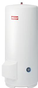
Résistance thermoplongeur ou blindée plongée directement dans l'eau. Cuve conforme aux normes d'hygiène grâce à son revêtement intérieur en émail vitrifié à haute teneur en quartz. Mise en place facilitée dans les placards de 600 x 600 mm grâce à la conception du capot et à la position du groupe de sécurité. Possibilité de passage des tubes sous l'appareil avec le socle de réhausse en accessoire (jusqu'à 200 L).
