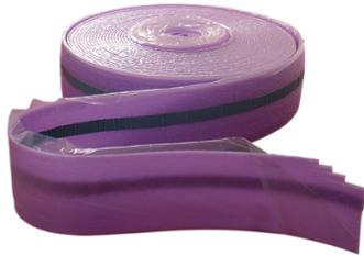
Permet de désolidariser la chape de toutes les parois verticales et évite ainsi les ponts thermiques en périphérie de pièce. Modèle avec bavette d'étanchéité, bande adhésive et pré-découpes. Épaisseur 8 mm. Rouleau de 25 m.
