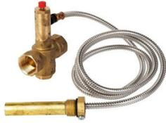
Soupape de sécurité thermique permettant d'éviter la surchauffe de la chaudière. Elle doit être raccordée à l'échangeur anti-ébullition sur une installation avec vase d'expansion fermé.
