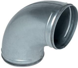
L'emboîtement / déboîtement se fait par une légère rotation de l'accessoire dans le conduit. Coudes emboutis jusqu'au Ø 250. Coudes secteurs du Ø 315 au Ø 560.
