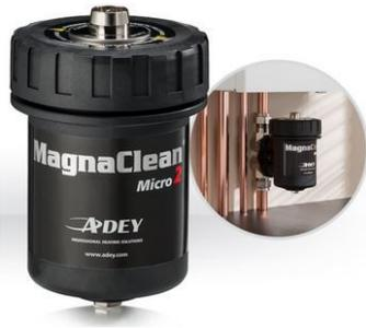
Filtre compact pour chauffage central domestique, protège les installations de chauffage central contre les dégâts causés par les boues et les dépôts. Installation horizontale et verticale jusqu'à 8 radiateurs. Température maximale de fonctionnement : 95°C. Pression maximale de fonctionnement : 6 bar. Hauteur minimale d'installation : 191 mm. Débit maximal : 50 L/min (3m<sup>3</sup>/h).
