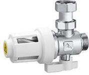
Filtre décanteur magnétique DIRTMAG XS pour chaudière murale. Fenêtre transparente pour optimiser le nettoyage. Pression max 3 bar. Plage 0/90°C. Maille du filtre 800 m
