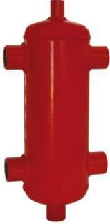
Corps acier, peint époxy. Raccords F1". Prise 3/8" pour purgeur. Pose 3/4" pour chasse. Pression maxi de service : 10 bar. Plage de température : 0/100°C
