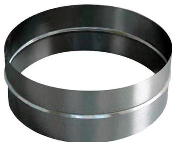
Ce raccord femelle de diamètre 160mm ou 200mm, permet de raccorder les conduits rigides circulaires des réseaux aérauliques. En acier galvanisé standard et facile à monter, par simple emboîtement, il participe à la bonne étanchéité des réseaux VMC collective et tertiaire.
