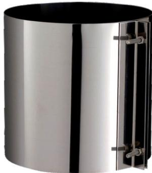
Manchon buse MB pour élément inox simple paroi Condensor, permet le raccordement d'un conduit en attente sur une buse chaudière dont le diamètre est sensiblement équivalent au diamètre du conduit.
