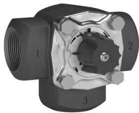
Plage de température 0°C à 120°C. Pression maxi. de fonctionnement : 10 Bar. Couple pour les 3 voies < 1 N.m. Corps de la vanne: Fonte. Boisseau ou papillon : Laiton. Angle de rotation 90°.
