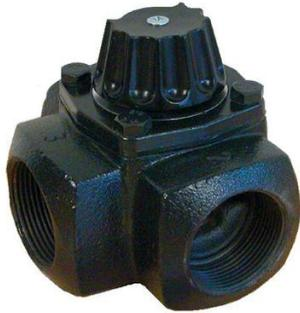
Température maxi. De fonctionnement : 110°C. Pression maxi. De fonctionnement : 10 bars. Angle de rotation 90°. Corps de la vanne : Fonte en laiton. Boisseau - papillon : Laiton.
