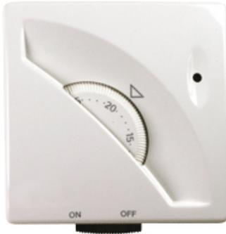
Thermostats d'ambiance avec contact inverseur. Plage de réglage 7°C / 30°C. Position hors gel 5°C. Indice de protection IP20. Alimentation 230V. Contact inverseur 16(2) A 250V. Dim : 80x80 mm.
