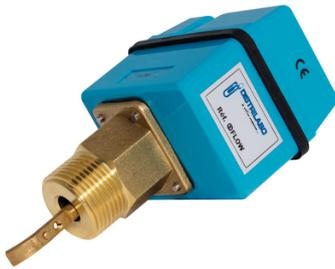
Signale la présence ou l'absence de débit dans les installations. Raccordement sur la tuyauterie 1" M. Pour montage sur tuyauteries de 1" à 8". Tension 240 V. ACS N° 03ACC PA002. Température maxi du fluide 120°C. Température mini du fluide -30°C.
