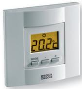
Thermostat d'ambiance filaire à touches pour chaudière ou PAC non réversible. Alimentation du boîtier d'ambiance : 2 piles LR03 (fournies). Sortie contact sec inverseur : 2 A. Plage de réglage de 5° à 30°C.
