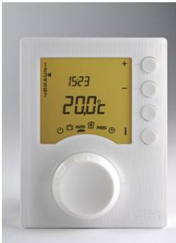
Thermostat programmable filaire pour chaudière ou PAC non réversible. Efficacité Energétique : Classe IV. Switch pour choix Journalier OU Hebdomadaire. Réglage de 2 niveaux de consignes : Confort - Réduit. Alimentation du boîtier d'ambiance : 2 piles LR03 (fournies). Sortie contact sec inverseur : 2 A. Plage de réglage de 5° à 30°C. Choix du pas de programmation , 1/4H - 1/2H - 1H. Programmation vacances et changement d'heure automatique.
