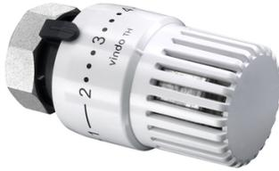
Bulbe liquide. Raccordement fileté M 30 x 1,5. Dispositif de limitation et blocage. Position « zéro ». Compatible malvoyants. Surface : blanche. Plage de réglage: 7-28 °C. Température de service max.: 120 °C.
