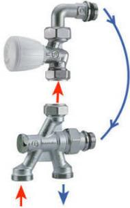
Robinet monotube à 4 voies. Spécial rénovation: Sens de passage inversé par le robinet. Ne pas tenir compte des flèches gravées sur la partie basse. Thermostatisable. Douille auto-étanche. Livré avec les deux adaptateurs pour la canne R194 Ø 16. Entraxe 35 mm pour alésage 16 et 50 mm pour alésage 18
