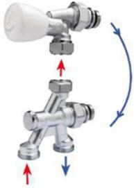
Robinet monotube à 4 voies. Thermostatisable. Douille auto-étanche. Livré avec les deux adaptateurs pour la canne R194. Entraxe 35 mm pour alésage 16 et 50 mm pour alésage 18.
