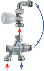
Robinet monotube à 4 voies. Thermostatisable. Douille auto-étanche. Livré avec les deux adaptateurs pour la canne R194. Entraxe 35 mm pour alésage 16 et 50 mm pour alésage 18A.
