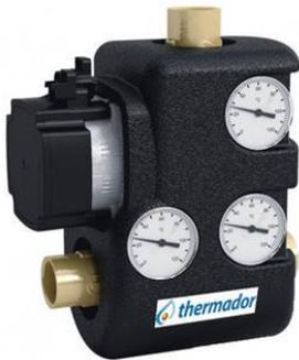
Kit complet permettant un recyclage vers le foyer tant que la température de consigne n'est pas atteinte. Livré avec 3 thermometres. Puissance max chaudière 65KW. Pression max 10bars. Débit max 2,8m<sup>3</sup>/H. Eau - Glycol max 50%
